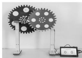
图3 多功能齿轮传动探究装置
