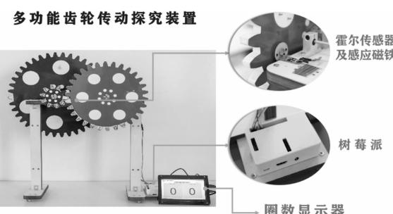
图6 多功能齿轮传动探究装置
