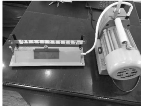
图2 将抽真空泵的出口端导入到金属导轨上
