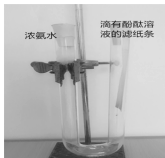
图 2 借助 U 型管改进分子运动现象实验
